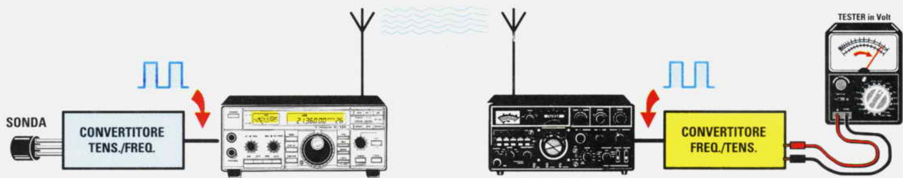
Fig.13 Modulando un trasmettitore con la frequenza generata dal sensore di Hall di fig.11 o dal sensore di temperatura LM.35/D di fig.14, potremo conoscere a distanza il numero di giri o la temperatura collegando al ricevitore lo schema riportato in fig.15.
