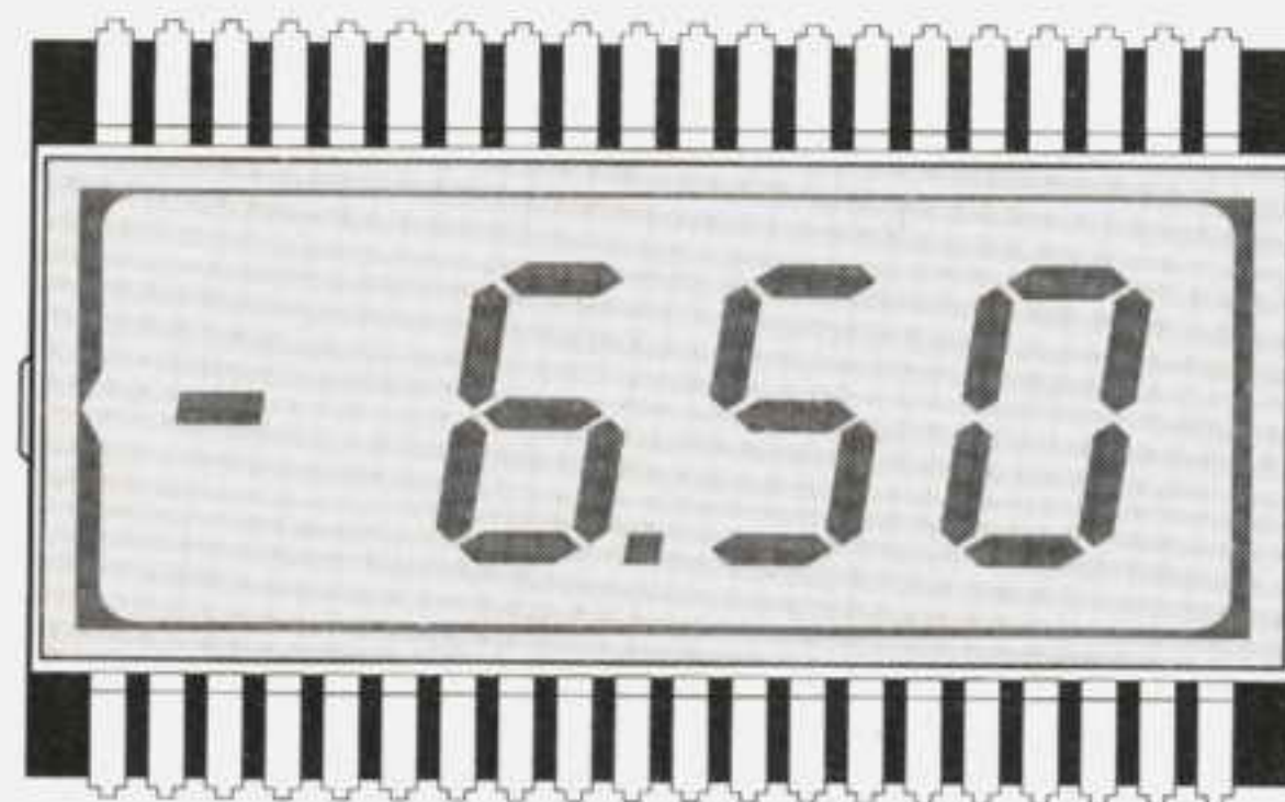
Fig.12 Spostando il deviatore S3 in posizione Audio, sul display LCD viene visualizzata la frequenza della portante Audio.
